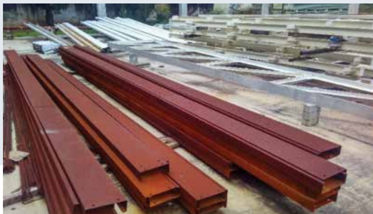
Estruturas metálicas armazenadas sem proteção apresentam corrosão Campus Ana Neri
