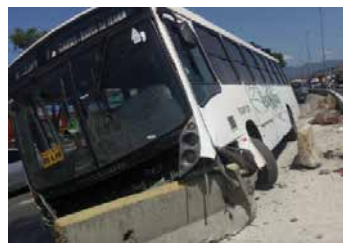
Colisão de veículo com barreira New Jersey
