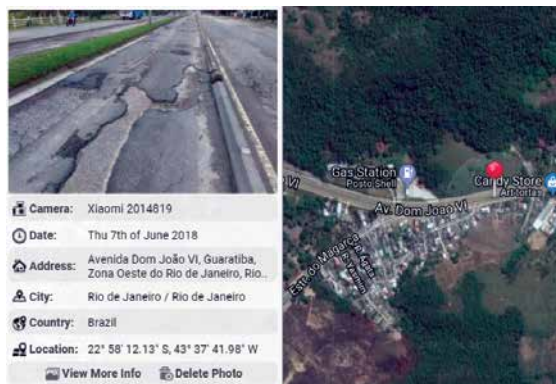
Defeitos em pavimentação. Camada de rolamento apresenta deformações permanentes, deslocamentos e trincas
