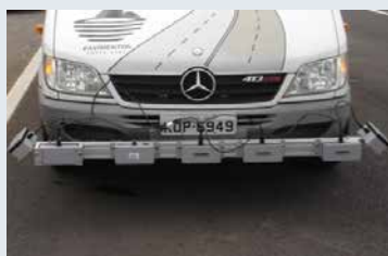
Realização de ensaio com perfilômetro a laser
